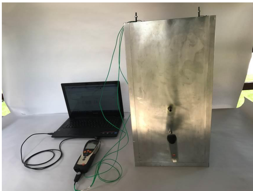
Slika 3: Izvedba meritev toplotne prevodnosti zelenega segmenta
